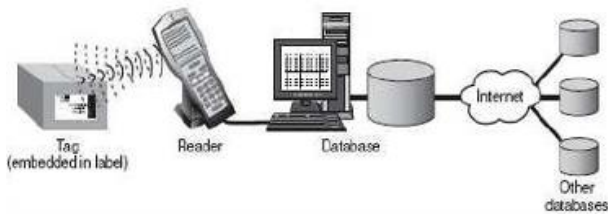
Gambar 3. Cara Kerja RFID Scanner dengan Perantara Gelombang Radio
